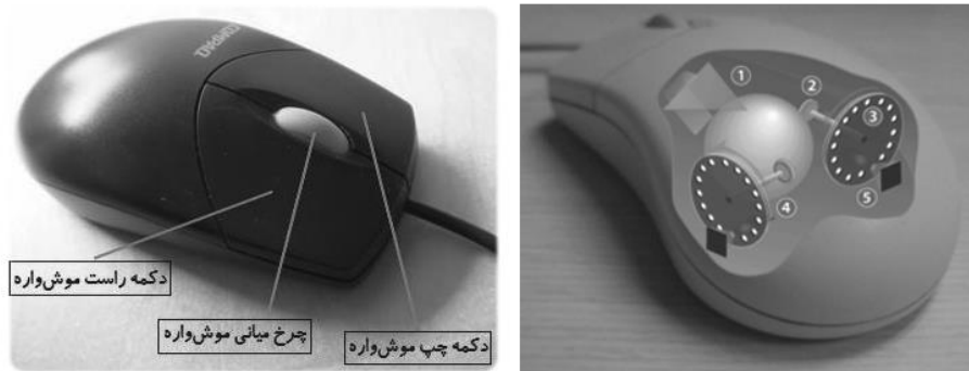
شکل ۲-۸: ساختار موشواره ی رایانه
